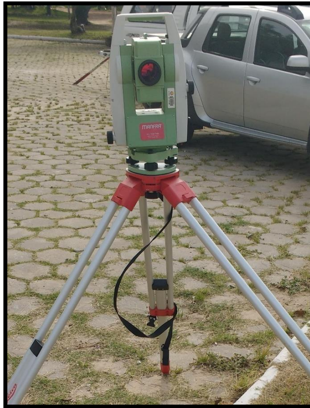
Figura 10: Estação total utilizada no trabalho de campo.
