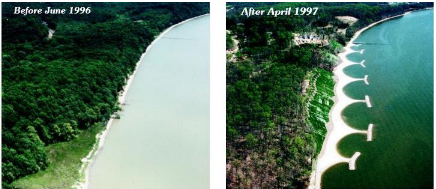
Figura 2: Sistema de proteção costeira chamado de Headland breakwater, conjuntamente a obra de enchimento de praia. Chesapeake Bay (EUA), FONTE: HARDAWAY e BYRNE (1999).
